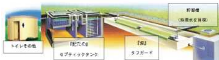
大成工業がインドで実証試験する、し尿排水処理装置「TSS」の仕組み（同社提供）
